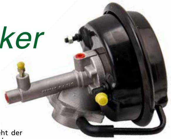
**H**äufig ist bei unseren Oldies ein hoher Bremspedaldruck notwendig um stark abzubremsen. Dann kann ein Bremskraftverstärker, kurz BKV, helfen. Einige unserer englischen Fahrzeuge wurden bereits sehr früh schon ab Fabrik mit einem BKV ausgerüstet. Bei anderen war es eine Bestelloption oder es gab sie nur ohne BKV.
