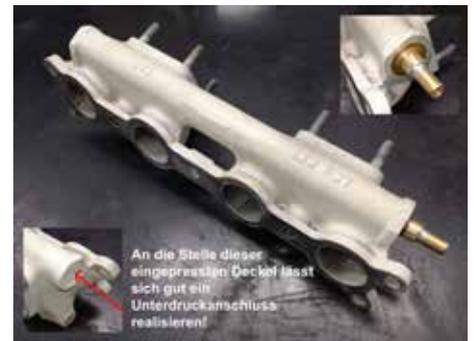
An die Stelle dieser eingepressen Deckel lässt sich gut ein Unterdruckanschluss realisieren!
