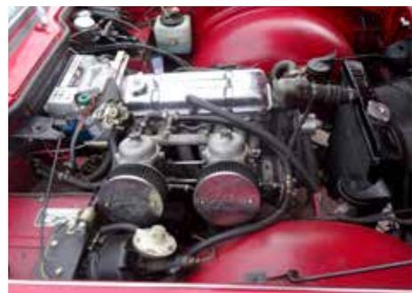
triebeschloß, Drehstromlichtmaschine, Zündanlage, Zusatzlüfter. Nach 4mal Kreuzgelenkwechsel an der Hinterachse 2015 Umrüstung auf homokinetische Antriebsseinheit.
