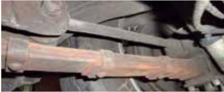
Sieht es so aus ist Handlungsbedarf! Die Feder wird ausgebaut indem die vordere und hintere Aufhängung entfernt wird und die Haltbügel der Hinterachse gelöst werden. Das Fahrzeug ist natürlich entsprechend aufzubocken.
