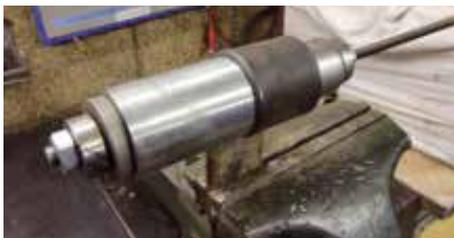
Die eingepresste Silentbuchse am vorderen Ende kann mit einer selbst gebauten Vorrichtung aus dem Federauge gezogen werden. Besser geht das auf einer Presse.
