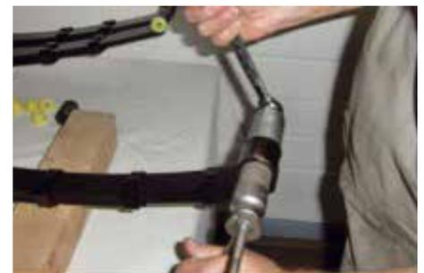
Mit dem gebastelten Werkzeug oder mit der Presse muss die vordere Buchse wieder eingezogen werden. Diese Buchse ist meist metallummantelt.
