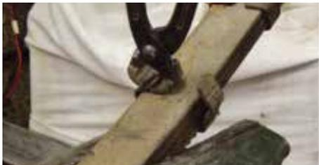
Um die Feder zerlegen zu können, müssen die Haltklammern geöffnet werden. Das kann man mit einer Zange bewerkstelligen oder bei stärkeren Bügeln mit Hammer und Meißel.
