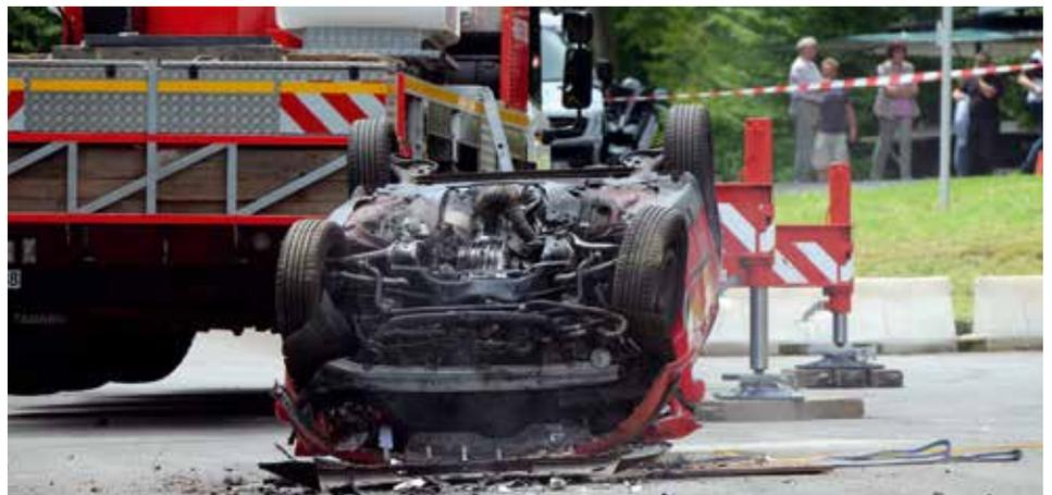
einem Kran aus frontal auf den Boden fallen gelassen, was einem Frontalcrash von 50 bzw. von 70 km/h entsprach.
