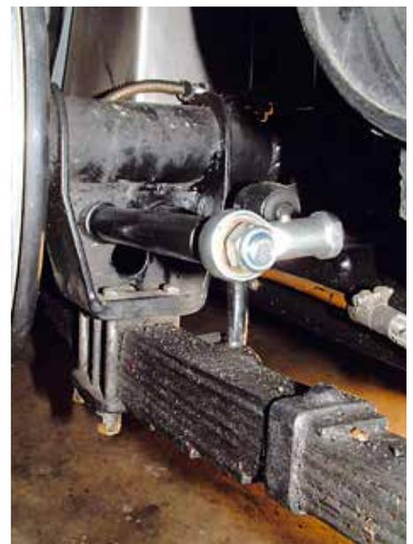
MG TC, Befestigung auf der linken Radseite an der Achse
