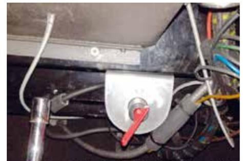
zu machen. Das ist sinnvoll wenn z.B. am Stromnetz gearbeitet wird oder wenn man das Auto für eine längere Zeit abstellt. Außerdem bietet die Trennung einen kleinen Schutz vor Diebstahl weil man den „Schlüssel“ vom Schalter abziehen kann.
