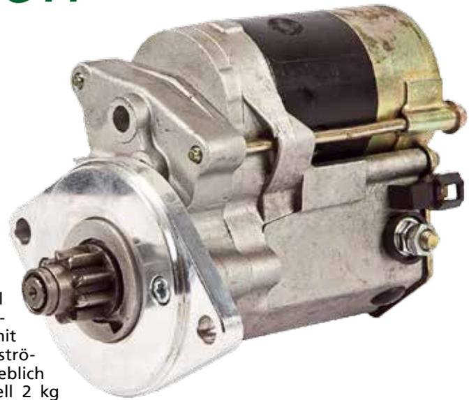
**D**ie Startermotoren (Anlasser) aus unseren Oldtimern benötigen enorm viel Strom. Deshalb brauchen wir relativ große Batterien und einen dicken Kabelanschluss zum Anlasser.
