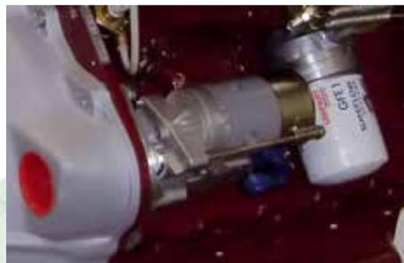
*Hochleistungsanlasser an einem MG MGA montiert*
