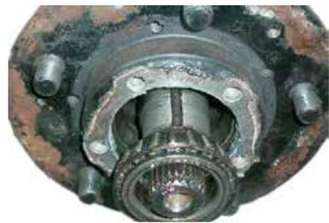
Kegellager nach dem Ausbau
